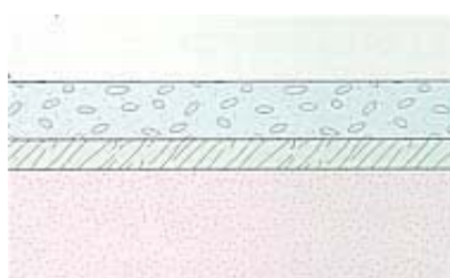
Поперечное сечение Ruspert® тип II
