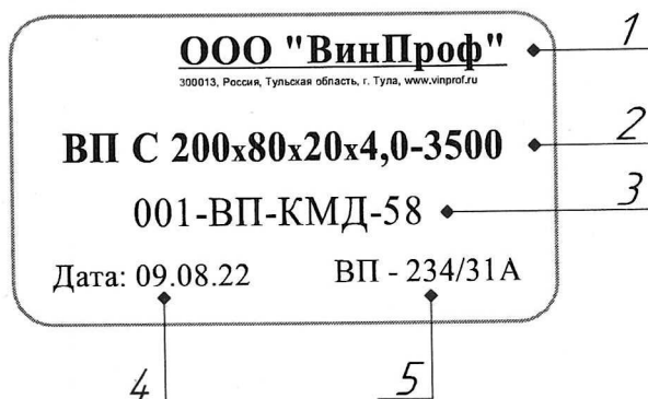
Рисунок Д1. Самоклеющаяся этикетка и позиции маркировки на ней.
